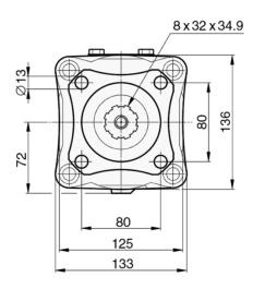
Shaft: DIN 5462 / ISO14 Mounting Flange: ISO 7653-D
